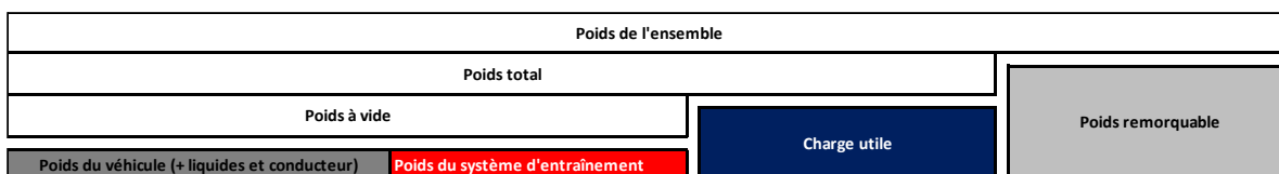
Figure 4. Influence du système d'entraînement sur la charge utile à disposition
