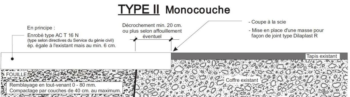
La pose du tapis à froid comme tapis définitif est exclue. Le tapis à froid posé comme solution provisoire est à remplacer dès que possible par un revêtement selon plan type.
