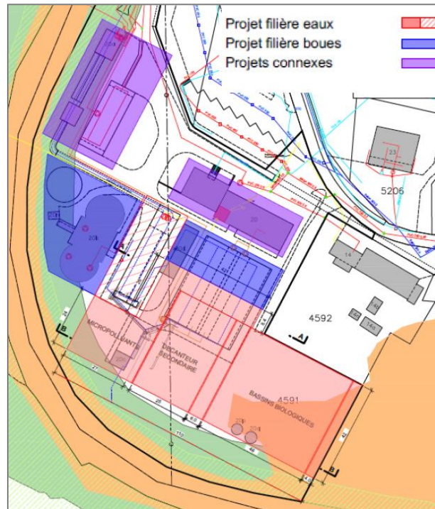
Figure 5 : Implantation des ouvrages prévus (avant-projet)
